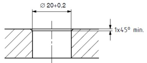
Aufnahmebohrung für Entlüftungsstopfen
