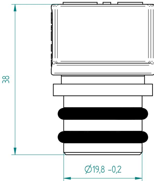
Aufnahmebohrung: 20+0,2 mm
