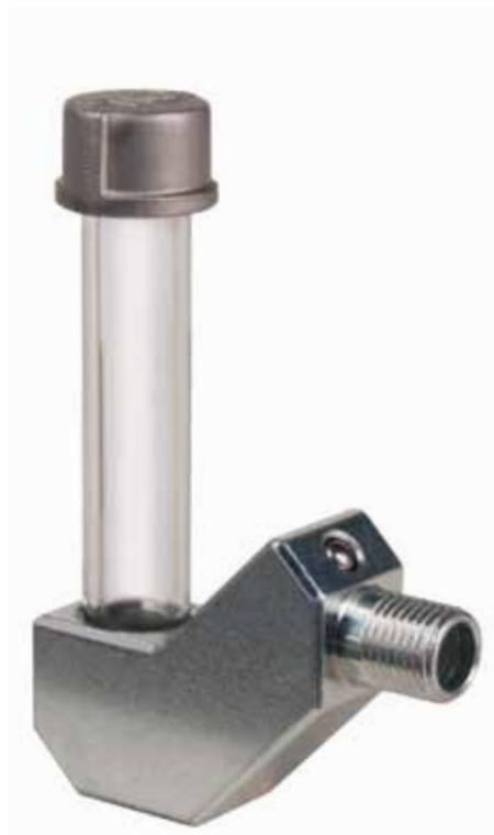
Der Vista Zero Pegelanzeiger zeichnet sich durch ein kompaktes Design und beste Rundumsicht aus. Die Besonderheit bei Vista Zero, besteht darin, dass das niedrigste sichtbare Niveau um 12 mm niedriger ist als bei der Normalausführung.
