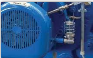
Watchdog-Öler, montiert auf der Mittellinie des gewünschten Ölstands
